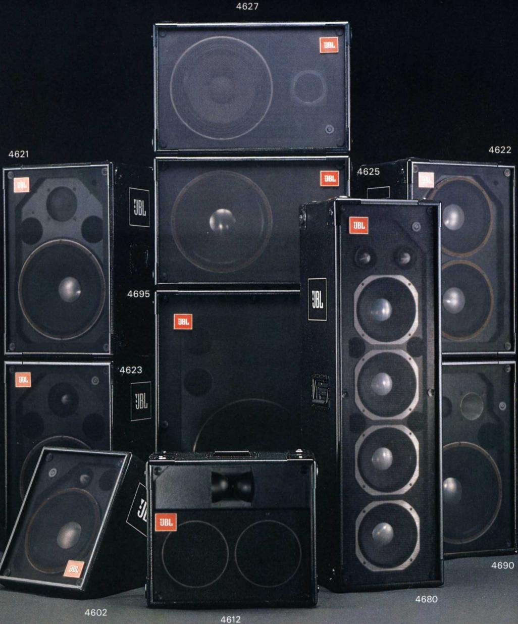
JBLのキャバレー・シリーズは、サウンド・リインフォースメント用及びミュージカル・インスツルメント用に開発したスピーカーシステムです。ステージショーなどで重視される音質と実使用的苛酷な条件を考慮して設計、そのコンパクトなシステムの中には幾多の歴史的なステージを成功させてきたJBLならではの経験と技術が投入されています。このシリーズは、目的に合せて10機種をそろえ、同時にシステムアップが自由にできるなどその用途を拡げています。エンクロージャーは高耐久性に徹した設計で19mm厚の硬質多層合板を使用、ポリウレタン塗装で外装コーティングし、強度を一段と高めました。また、輸送中にユニットやグリルクロスを保護するフロントカバー、スタッガ使用時の積み重ねに便利な形状をもつボリカーボネート製のコーナーガード、そして持ち運び用の取手を設けるなど細心の配慮をしています。その他、2ウェイモデルには高域用連続可変アッテネーターを備えています。
