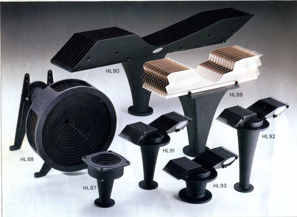
● **ホーン/レンズHL87/HL88** 内径が異なる多孔性リング状パンチメタルを重ねた独特の音響レンズで、中高音を円錐パターンに拡散します。HL87は5枚の音響レンズとエキスポネンシャルホーンで構成、LE175、LE85と組合せて1.2kHz以上で使います。14枚の音響レンズを採用“蜂の巣”の愛称をもつHL88は376と組合せ、中高音を円錐形に70°の指向特性をもって拡散します。設置の際は付属スタンドを使用します。
