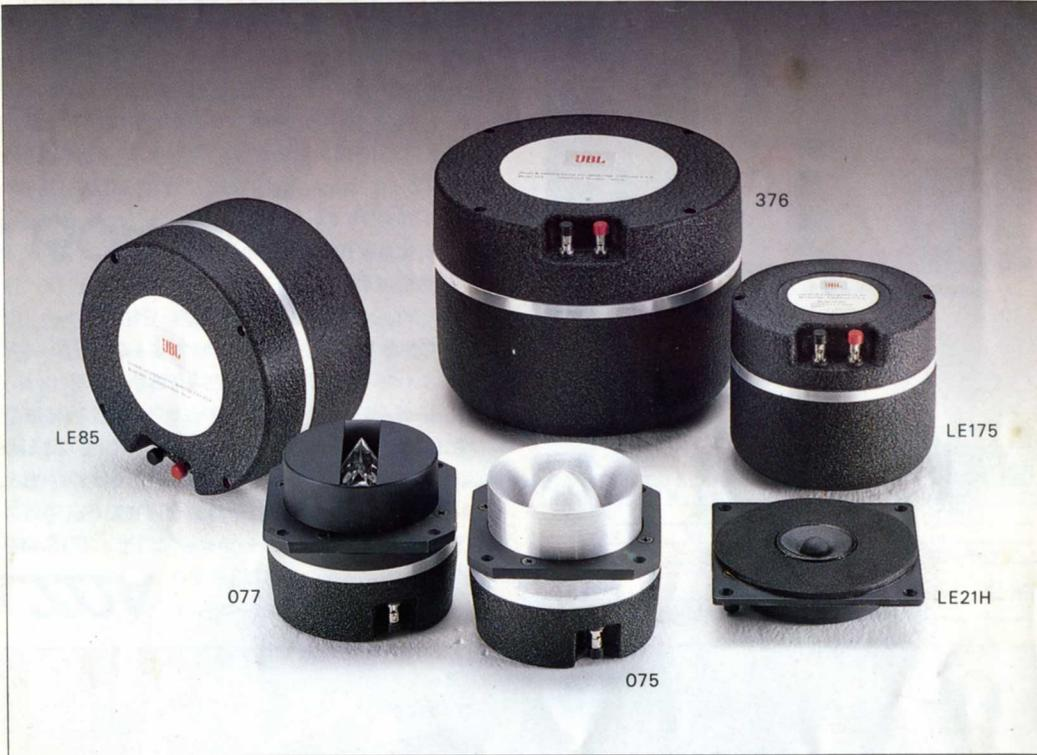
● **ホーンツイーター-075/077** 精巧な技術を具現した075は独特のリング状ダイアフラムとアルミのムク材を使ったホーンで構成した高効率ホーンツイーターです。指向特性に優れ、同時に2ウェイでは2.5kHz以上、3ウェイでは7kHz以上で使用できるワイドレンジ特性を誇ります。スーパーツイーター077は指向特性を大幅に改善した独自のホーンを採用、16kHzで90°×30°の広拡散性を実現、同時に可聴帯域を超える超高域までフラットに再生しています。透明感溢れる音質の075、077ともJBLオリジナル技術が生きる斬新なデザインです。
