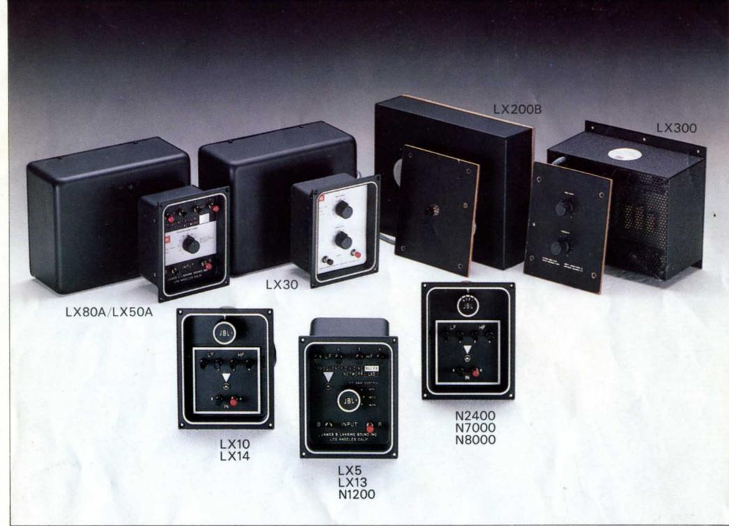
● **フリクエンシー・デバイディング・ネットワーク** JBLの秀作ユニットを組合せた2ウェイ、3ウェイのスピーカーシステムがベストサウンドを再生するためにはネットワークが重要な役割を果たします。JBLのネットワークは単に音響信号を分割するだけでなく個々のユニットの特性に合わせて設計しており、それぞれ適合するものを組合せることにより優れた音質を実現します。ネットワークを構成するパーツも、正確なノンポーラ・コンデンサー、入念に加工された精密インダクター、精密アッテネーターなど厳選したものを採用、インピーダンスや位相、歪など音質を左右する音響特性を十二分に検討してつくられています。そのため、2～3ウェイにした時はより滑らかなレスポンスを実現するとともに低音域から高音域への移行を全く感じさせない自然な音の
