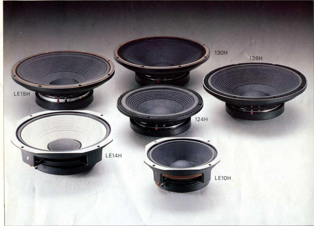
●**ウーファー-136H/124H** JBLのスタジオモニターのウーファーと同一の特性、音質を備えたウーファーで、136Hは38cm径、124Hは30cm径です。大型磁気回路、10.2cm径ボイスコイル、そして再生帯域を超低音域まで伸ばすとともに低歪化など特性を改善した独自のマスコントロールリングなど主要パーツは同じものを採用。許容入力は200Wと大きく、フラットな特性をもち、パワフルでクリアな低音を再生します。
