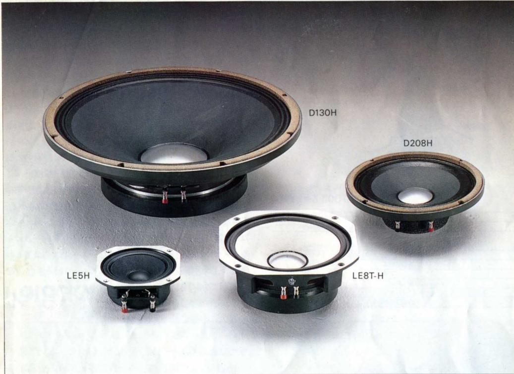
●**38cm径ワイドレンジD130H** JBL創立当時から30余年にわたってロングセラーを続ける38cm径ワイドレンジの傑作。10.2cm径アルミリボン線ボイスコイル、軽量カーブドコーン紙、低歪率の大型強力磁気回路、透明な中高音を再生するアルミセンタードームなどJBLの技術の原点が随所に生きています。2ウェイ化することで、能率のよい音楽性豊かな音を再生します。
